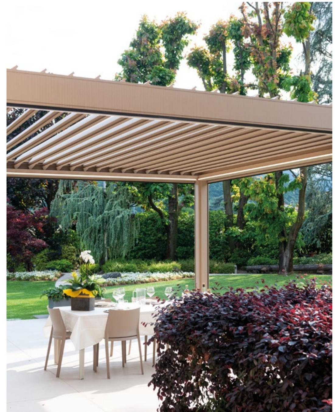
Il sistema frangisole è costituito da lamelle in lega di alluminio, orientabili elettricamente da 0° a 135°, che consentono una costante regolazione dell'esposizione al sole, favorendo l'abbassamento della temperatura e l'ottimizzazione del ricambio d'aria. Le lamelle sono complete di guarnizioni ermetiche in silicone, che ne garantiscono una perfetta tenuta a pioggia e neve.
